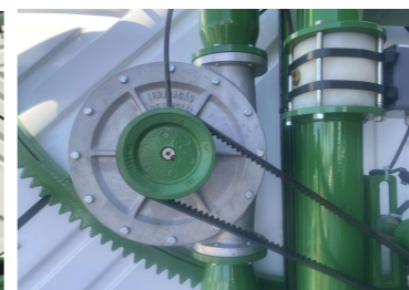
Turbina Hidráulica em Alumínio / Moto Redutor
