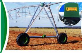
**H- TORRE DO CONJUNTO DE RODAS** ♦ As torres do conjunto de rodas estão dimensionadas para suportar grandes cargas e movimentos em terrenos irregulares.
