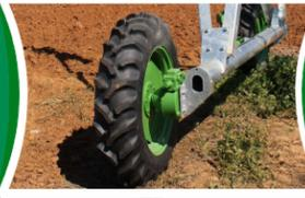
**E- CONJUNTO DE RODAS E REDUTORES** ♦ Composto de viga base, rodas, pneus e redutores de velocidade. Dimensionados para suportar esforços e cargas em situações de terrenos mais adversos. Podem ser equipados com pneus 11.2" x 28", 12.4" x 24" ou 14.9" x 24".
